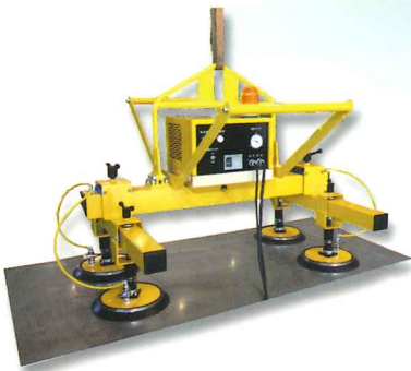
定尺鋼板搬送用 (0.5t 吊り)
