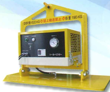
ブロック鋼材搬送用 (1.5t 吊り)
