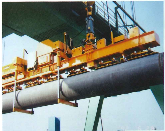
鋼管用 バキュームリフト (18.3t 吊り)
