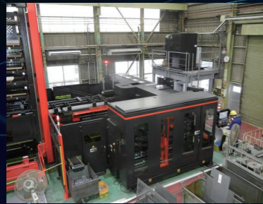
タレパンレーザー複合加工機 (2018年12月導入)
